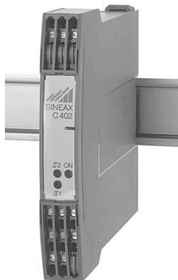
Fig. 1. SINEAX C 402-1 avec 2 sorties relais avec 1 contact commutateur chaque, en boîtier S17 encliqueté sur rail «en chapeau».
